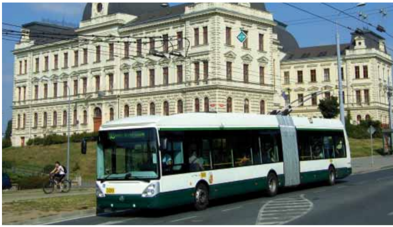
Vozový park omladilo v minulých dnech pět nových plně nízkopodlažních trolejbusů Škoda 25 Tr s karosérií Citelis omladí vozový park trolejbusů. Všechny jsou vybaveny pomocným naftovým agregátem, který umožní operační řešení výluk a požadavků na přepravu. Foto Štěpán Esterle
