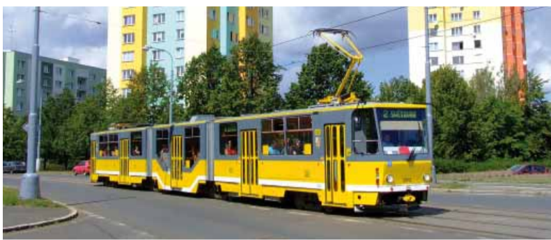
Na konci tohoto roku bude již všech 12 kloubových obousměrných tramvají po kompletní modernizaci a s novým středním článkem pro bezbariérový nástup cestujících s pohybovým postižením a maminky s kočárky. U tohoto populárního typu vozů z přelomu 80. let a 90. let jdou všechny české dopravní podniky cestou tohoto způsobu modernizace. Foto Jan Šlehofer
