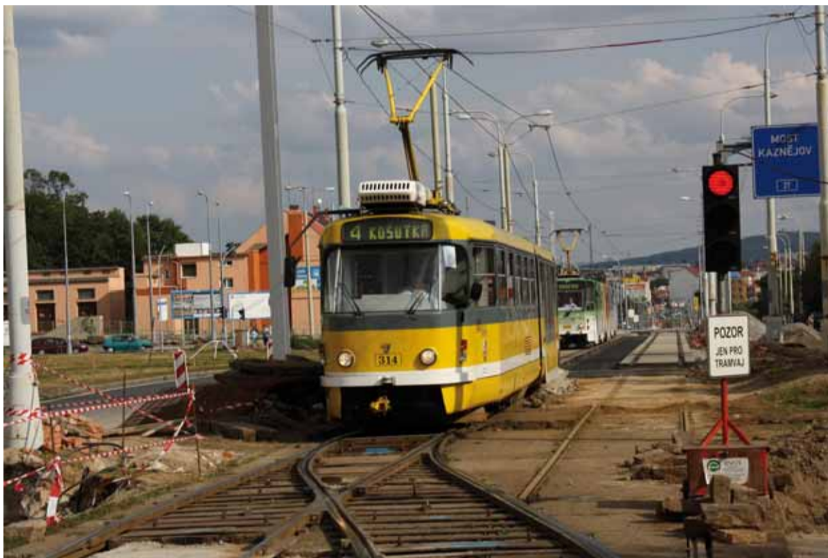
14. 8. 2009 zaznamenal fotograf kloubovou tramvaj K3R-NT před tzv. „kalifornianem“, což je mobilní výhybka sloužící k přecedení obousměrného provozu tramvají na jedinou kolej. Provoz byl samozřejmě řízen semaforem a především ve špičkách dispečery, kteří zajišťovali průjezdy tramvajových konvojů. Foto Jan Šlehofer
